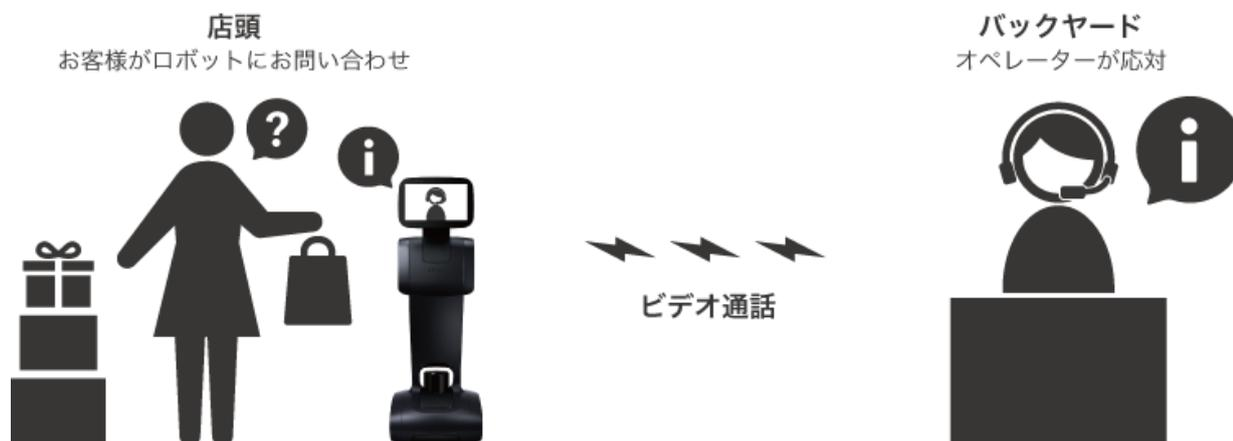
「temi」は、人間が遠隔から操作をする「アバターロボット」に分類されるロボットです。専用のスマートフォンアプリを使用し、離れたところに設置されたtemiにアクセス、ロボットに装備されたタブレットを通じてtemiの周辺に居る人とビデオ通話をすることや、アプリからの操作により、temiを自走させ、移動させることも可能です。
